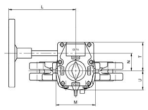
Getriebewerkstoffe / Gear materialsGehäuse / Body:Grauguss / cast ironWelle/Stem:Stahl / steelHandrad / Handwheel:Stahl / steel
