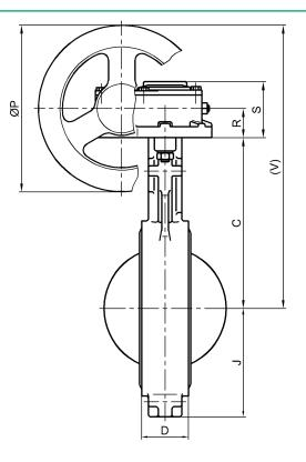
Getriebewerkstoffe / Gear materialsGehäuse / Body:Grauguss / cast ironWelle / Stem:Stahl / steelHandrad / Handwheel:Stahl / steel
