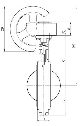
Getriebewerkstoffe / Gear materials Gehäuse / Body: Aluminium / aluminium Welle / Stem: Stahl / steel Handrad / Handwheel: Stahl / steel
